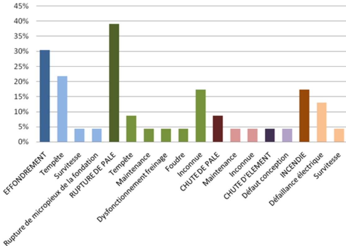
Par ordre d'importance, les accidents les plus recensés sont les ruptures de pale, les effondrements, les incendies, les chutes de pale et les chutes des autres éléments de l'éolienne. La principale cause de ces accidents est les tempêtes.
