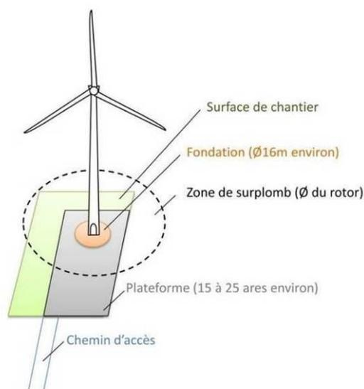
Figure 6 : Illustration des emprises au sol d'une éolienne
