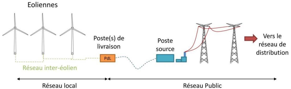
Figure 3 : Raccordement électrique des installations
