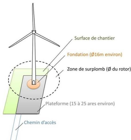
Figure 2 : Illustration des emprises au sol d'une éolienne
