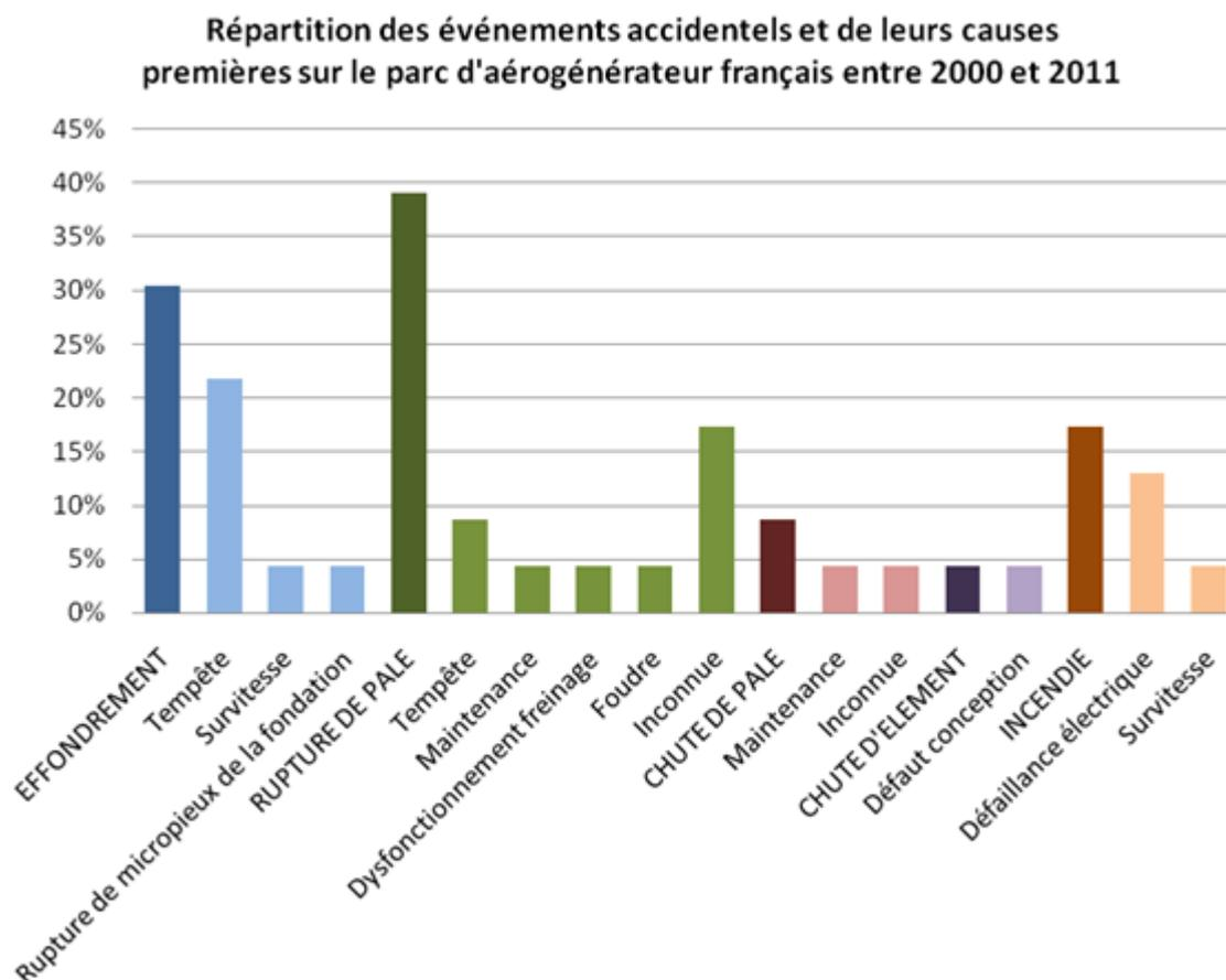
Par ordre d'importance, les accidents les plus recensés sont les ruptures de pale, les effondrements, les incendies, les chutes de pale et les chutes des autres éléments de l'éolienne. La principale cause de ces accidents est les tempêtes.
